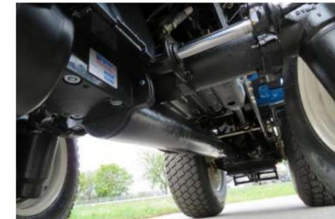
**Frontzapfwelle 2000U/min, gewuchtete Präzisionsgelenkwelle, unter Last unabhängig weich zuschaltbar, Zapfwellenprofil 1"-15 Nuten**
